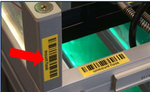
9. Den neu eingelegten Flasks den jeweiligen Port zuweisen (zuerst Port-Barcode scannen und zweitens den Barcode auf der Flask scannen, dabei auf grünes Bestätigungsblinksignal an Schublade achten):
