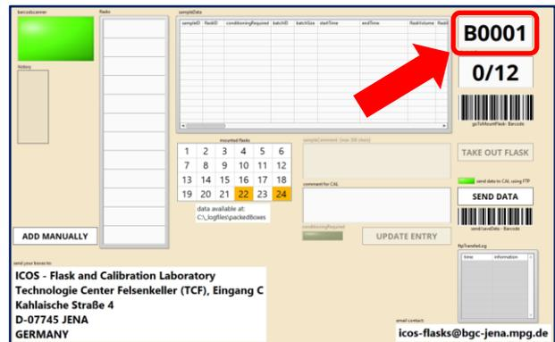
5. Flasks die entnommen werden sollen scannen, dabei auf grünes Bestätigungsblinksignal an Schublade achten (es kann der Barcode auf dem Bügel oder auf der Flask verwendet werden, das ist egal), anschließend überprüfen ob alle Flask gescannt wurden. Wenn alle Flasks aufgelistet werden, den „Send Data“ Button drücken (oder mit dem Barcodescanner den „send/save Data“ Barcode scannen):
