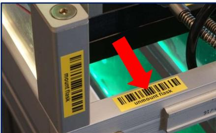
3. Flasks die entnommen werden sollen scannen, dabei auf grünes Bestätigungsblinksignal an Schublade achten (es kann der Barcode auf dem Bügel oder auf der Flask verwendet werden, das ist egal), anschließend überprüfen ob alle Flask gescannt wurden.
