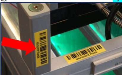
8. Den neu eingelegten Flasks den jeweiligen Port zuweisen (zuerst Port-Barcode scannen und zweitens den Barcode auf der Flask scannen, dabei auf grünes Bestätigungsblinksignal an Schublade achten):
